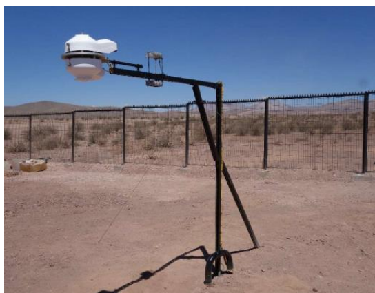
Figura 30 - Albedómetro con dos celdas de referencia y dos piranómetros
